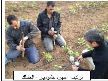
تركيب أجهزة تشوميتير - الجفتاك
