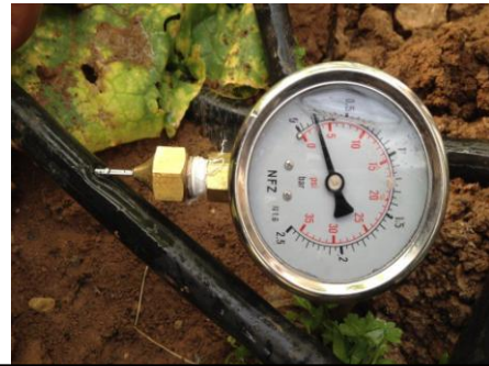
ساعة قياس ضغط لتقييم كفاءة شبكات الري - الجفتاك
